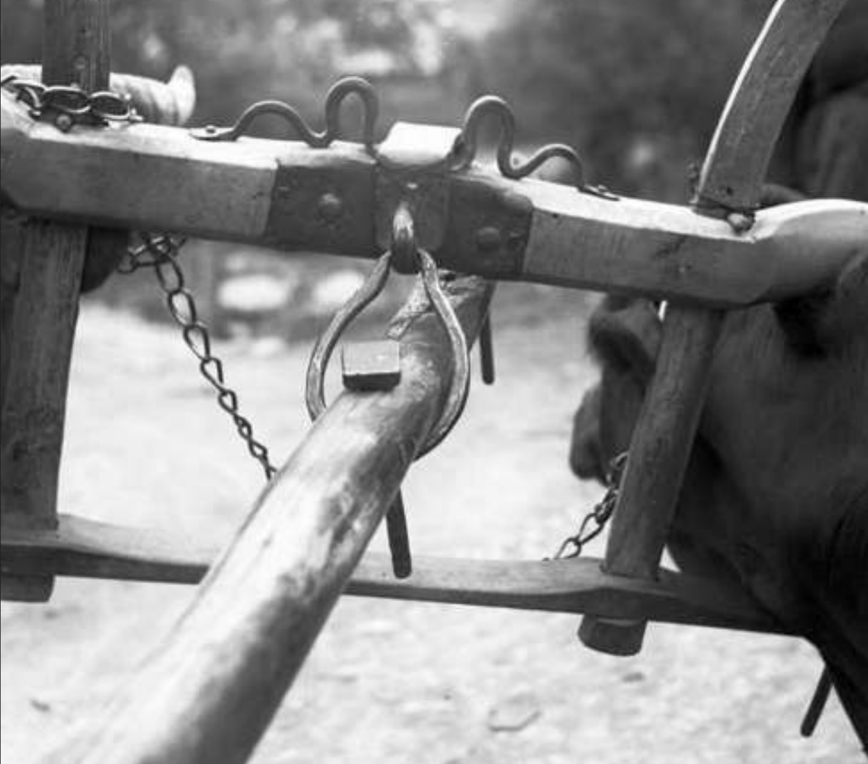
V horských oblastiach, kde hrozilo prevrhnutie voza, pripínali oje k jarmu pomocou otočného zariadenia, – kocúra. Veľký Lipník. Foto J. Podolák, 1967
